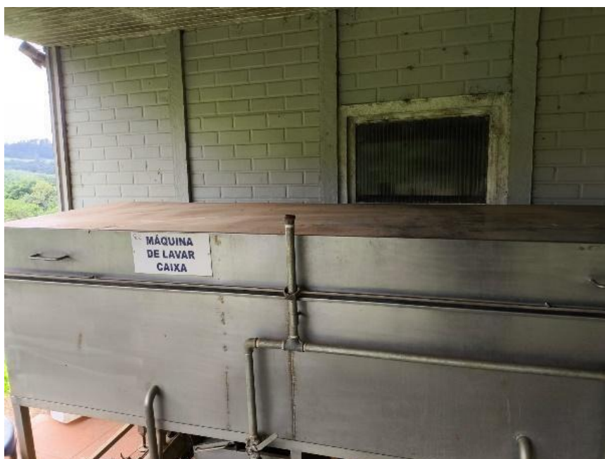
Figura 8 – máquina de lavar caixa plástica em inox 430 -2500x880
